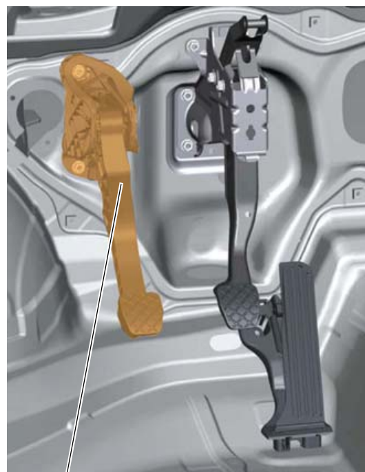
Педали сцепления с датчиком ее положения
